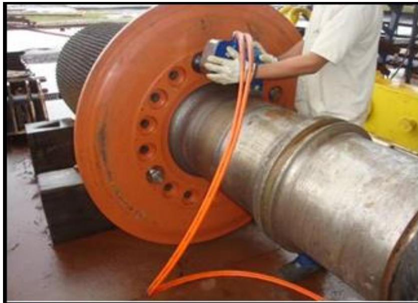
FIGURA 6 - Montagem dos parafusos no flange
